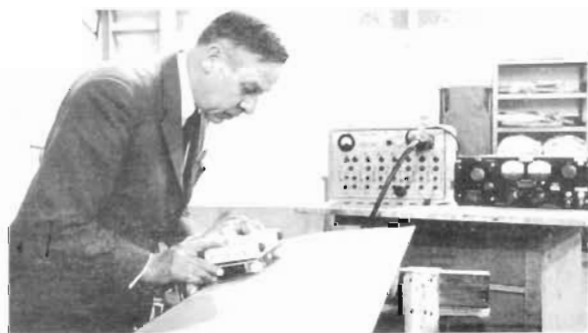
ingenjör Sten Karlsson CVV letar sprickor på rotorblad med MLF-apparatur.
