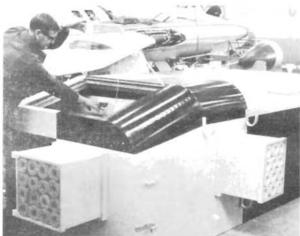
När aggregatet körs står dämpkåpan på golvet. De utstickande lädorna med runda insatser är ljudfällor.
