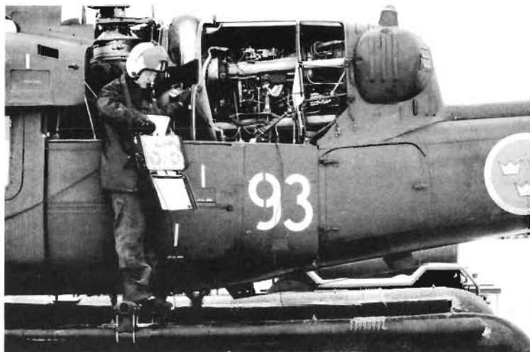
1 fte Hans Karlsson, F3 spelar in vibrations signaler från motorn på en HKP3.
